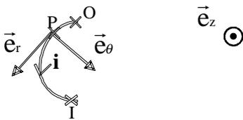
On choisit un point P courant d'une ligne de courant quelconque et nous **montrons** que la f.e.m ne dépend pas de la forme de la ligne; tout se passe comme si le courant était purement radial (tout au moins en ce qui concerne l'aspect électrique des phénomènes).
